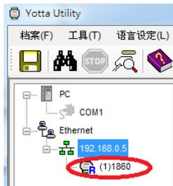
3. 当完成装置点选后, 可在 YottaUtility 右边窗口监视所有 IO 状态, 并可直接用鼠标点选 DO 执行强制输出动作。
