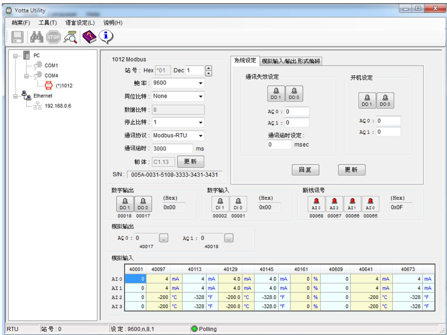
8. 可由上图完成各项参数设置，于完成时点选「更新」按键。并将 A-1012 模块背面开关切换至 Normal 位置。
